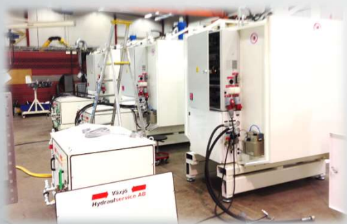
Ändformnings maskin för rör på bilindustrin
